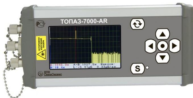
У пользователей прибора появились дополнительные возможности. Теперь пользователь может непосредственно на дисплее прибора подробно разглядеть мелкие неоднородности линии. Отображение результатов измерения расстояния и затухания с помощью курсоров стало более наглядным. Ввод текстового комментария в процессе сохранения рефлектограммы выполняется с помощью сенсорного экрана.
